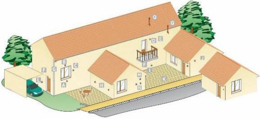
Şekil 83 (a). Denge duman yolu baca konfigürasyonları çıkışlarının konumu
