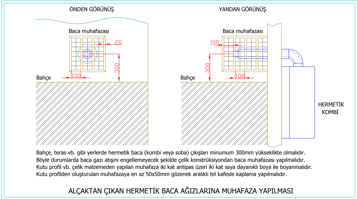
Şekil 85. Hermetik (konsantrik bacalı) cihazlar bahçe çıkışları
